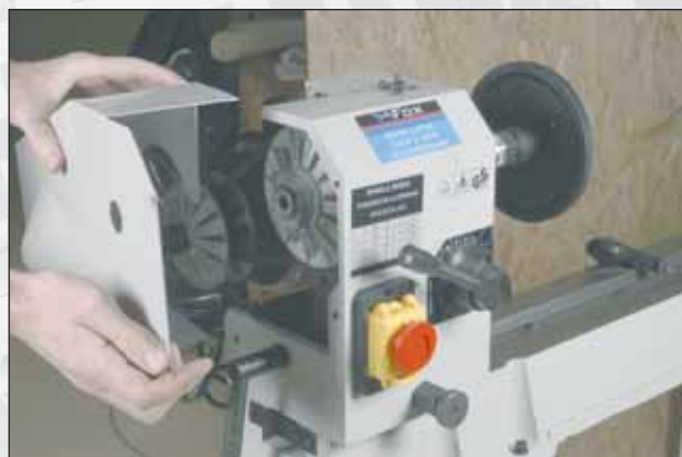
Photos 1 et 2 : démontage du carter de protection.
