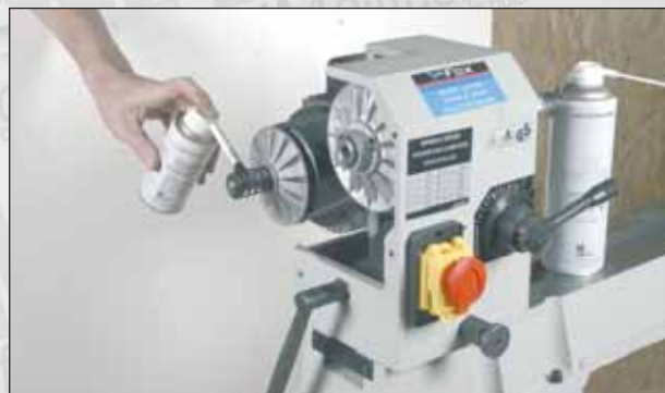
Photo 4 : lubrification des axes des poulies
