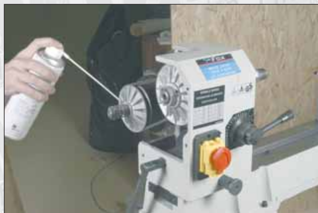
Photo 3 : nettoyage de l'intérieur du capot de protection.
