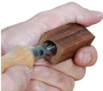
L'araseur à main est prévu pour la réalisation des stylos standards à tubes laiton de diamètre 7 mm uniquement.
