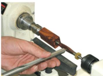
Le mandrin se compose d'un cône Morse et d'une tige sur laquelle on fixe les carrelets. Le cône Morse s'insère dans la poupée fixe du tour (côté moteur) tandis que l'extrémité de la tige, fraisée en bout, prend appui sur la contrepointe de la poupée mobile.
