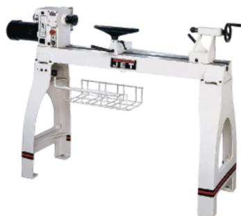
La poupée fixe n'est pas pivotable mais est déplaçable tout le long du banc et permet donc le tournage frontal en extrémité de celui-ci.
