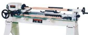
Copieur, pour dupliquer une pièce à plusieurs exemplaires. Un palpeur suit un gabarit de votre fabrication ou un modèle de pièce déjà réalisée.
